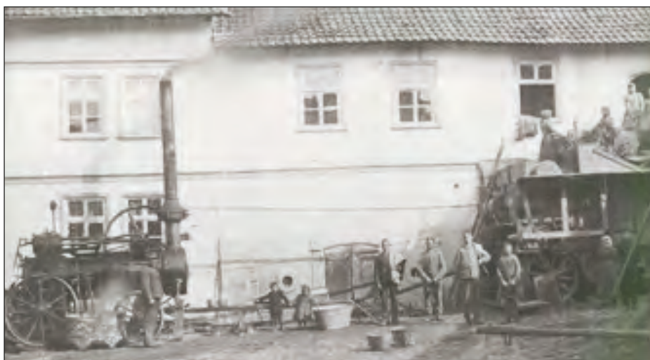
Die Dreschmaschine (rechts) im Einsatz auf dem Hof Schäfer im Jahre 1927, angetrieben durch eine Dampflokomobile (links), welche die Dreschmaschine auch zum nächsten Bauernhof zog. Im Hintergrund ist das Gasthaus „Zum Stern“ zu sehen, in dessen Saal im ersten Stock noch bis zum Neubau der Festhalle 1953 die Friedewalder Kirmes gefeiert wurde.
