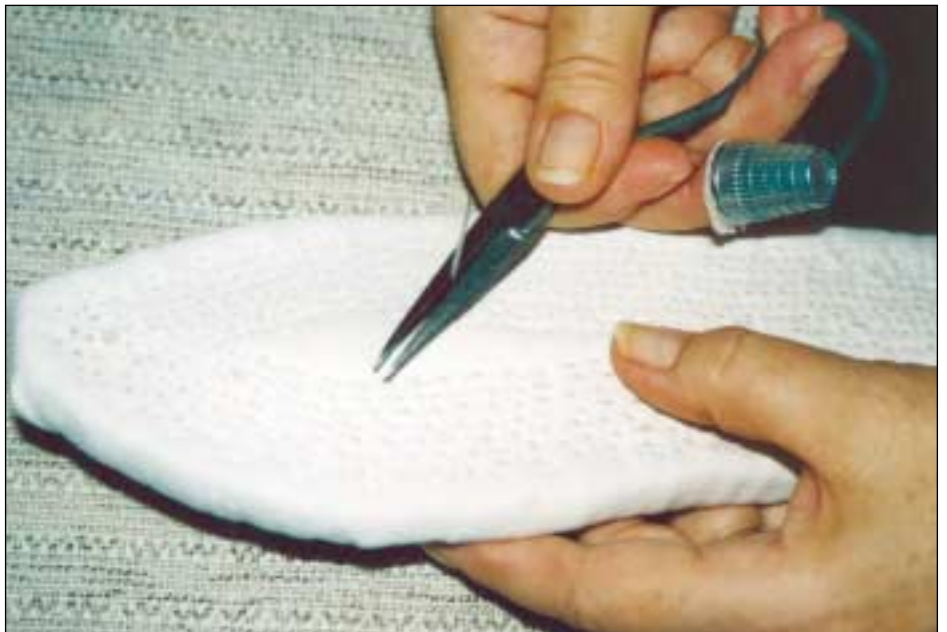
(3) Steppen der Stoffsohle mit Latschennadel, Zange und Fingerhut.
